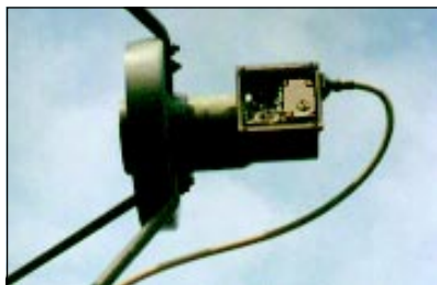
Конвертер диапазона С со снятой крышкой. Виден винт регулировки частоты
